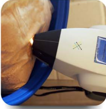
Şekil 3. µPHAZİR istenilen yere taşınabilir. Analiz için Polietilen ambalajların açılması gerekmektedir.
